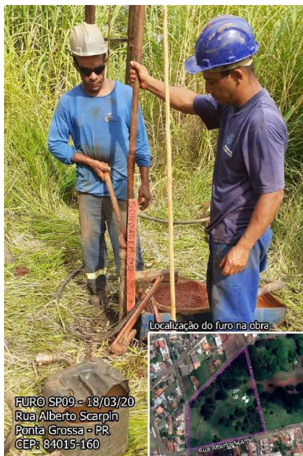
Figura 36: Vista geral da execução do furo SP09 e sua localização
