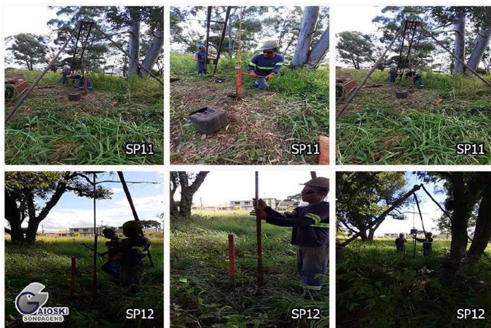
Figura 7: Execução sondagem furos SP11 e SP12 – ENAR ENGENHARIA E ARQUITETURA LTDA
