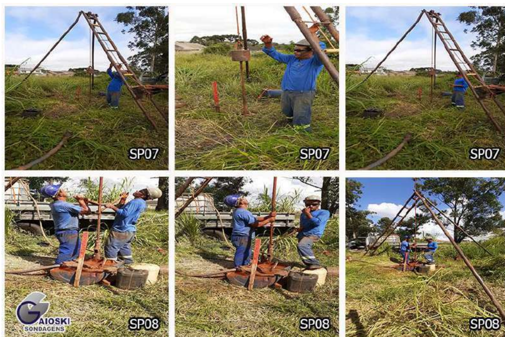
Figura 5: Execução sondagem furos SP07 e SP08 – ENAR ENGENHARIA E ARQUITETURA LTDA
